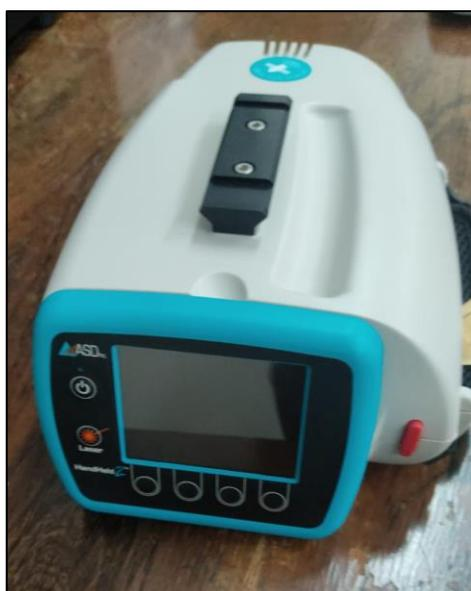
Figura 8. Espectrorradiômetro portátil ASD FieldSpec HandHeld 2 PRO.
